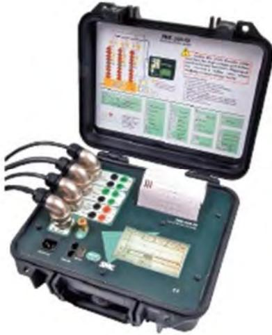
Тестер PME-500-TR новейшая разработка компании EuroSMC в области испытания высоковольтных выключателей, благодаря новому и простому методу тестирования PME-500-TR обеспечивает высокую надежность, позволяет экономить время и увеличивать продуктивность работы.
